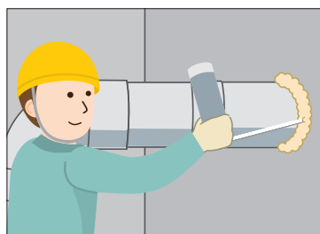
配管貫通部の充填
