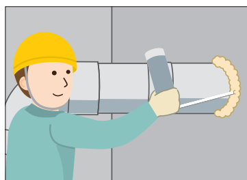
配管貫通部の充填
