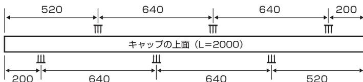
図-11 高さ調整用レベル合わせ、目地割り墨、水糸(例)
